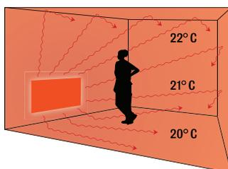
**Strahlungswärme wird durch elektromagnetische Wellen mit Wellenlängen im Infrarotbereich übertragen. Sie durchdringen die Luft nahezu verlustfrei. Erst beim Auftreffen auf feste Körper erzeugen Sie Wärme.**
